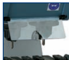
5 Protection pour copeaux.
