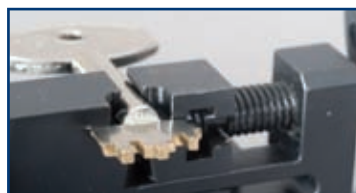
8 Eaux striés, permettant un serrage optimum des clés.
