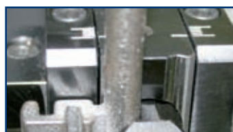
6 Eaux latéraux réglables pouvant copier sans difficultés toutes les clés à chiffres.
