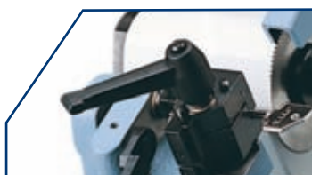
1 Système réversible à double mâchoire, à trois positions qui permet: a) Duplication de clés à gorge d'un panneton et double panneton. b) Duplication de clés frontales. c) Duplication de clés spéciales (FO-4P).
