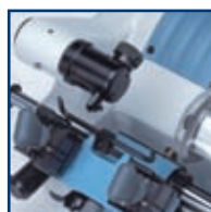
2 Réglage de profondeur micrométrique.
