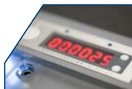
1 Première machine équipée d'un compteur journalier et intégral, permettant de contrôler et de comptabiliser le nombre global et partiel de clés taillées.
