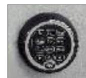
Serrure de coffre-fort électronique Sargent et Greenleaf réf. Z03 Rotary Bolt testée A2P niveau B/E. Pêne oscillant. Capacité 10 codes, 1 maître, 1 superviseur, 8 utilisateurs (dont 1 convoyeur). Temporisation de 0 à 99 minutes.
