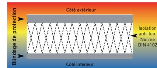
Isolation anti-feu norme DIN 4102 : pour protéger vos armes et vos documents contre le feu, l'espace entre les parois est garni d'un matériau ignifuge qui résiste à de hautes températures. Le joint anti-feu placé autour de la porte se dilate en cas d'incendie pour coller à la paroi du coffre et assurer une protection contre les flammes, les gaz, la chaleur et l'eau.
