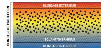
Dans un coffre sans isolant, la température s'élève très rapidement lors d'un incendie. Avec les coffres série MB, vos documents seront mieux protégés. La performance des matériaux ignifuges aux normes DIN 4102 ralentit considérablement la montée de la température interne.
