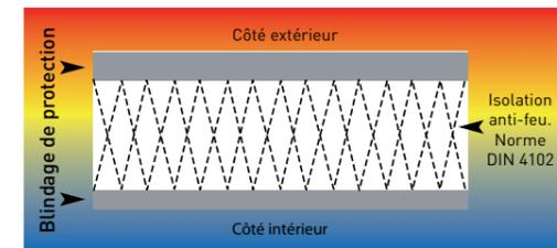
Protection anti-feu. Isolation anti-feu. Norme DIN 4102 pour protéger vos armes et vos documents contre le feu, l'espace entre les parois est garni d'un matériau ignifuge qui résiste à de hautes températures.
